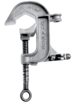
C6002256 Cuerpo de aluminio, Mordazas dentadas, Perno de bronce con ojal con rosca Acme Roscado para Casquillo roscado UNC de 5/8-11
