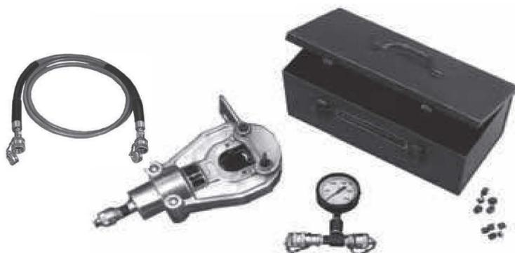
El Cabezal MVC8U tiene 4 indentaciones adicionales marcados "ST" para usarse en todos los manguitos interiores de acero de los mangos ACSR
